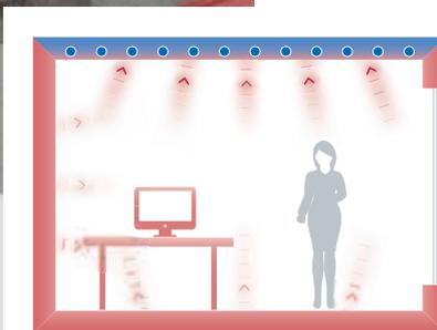
Dasselbe Prinzip kann man sich im Sommer zum Kühlen zunutze machen. Durch die Rohre der KE KELIT Aktivdecke wird dann ganz einfach statt heißem kaltes Wasser geschickt. Der ganze Raum wird sanft gekühlt – und zwar, ohne dass dabei unangenehme Luftströme entstehen.
